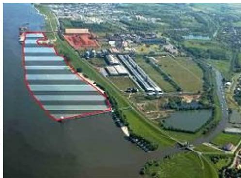
Auf rund 220 000 Quadratmetern, also etwa auf der halben Fläche der für Bützfleth vorgesehenen Seehafenerweiterung, betreibt Steinweg einen Terminal nahe der Hamburger Speicherstadt. An der 1100 Meter langen Kaimauer können Seeschiffe mit maximal 11,50 Meter Tiefgang anlegen. In einer 80 000 Quadratmeter großen Lagerhalle werden Waren zwischengelagert, umverpackt und konfektioniert, erläuterte der Chef der Hamburger Niederlassung Ulf Boll dem Ausschuss.
