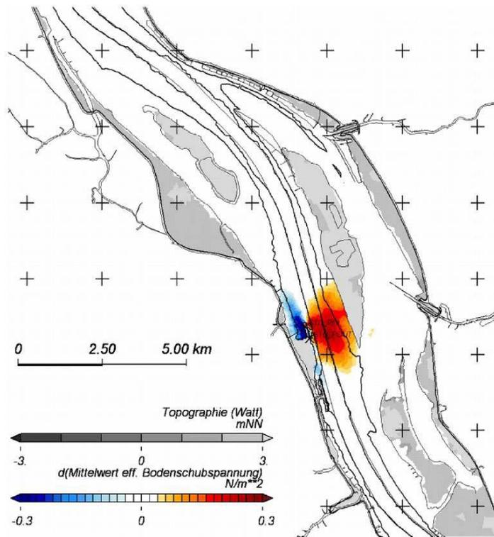
**Abb. 32: Änderung der mittleren effektiven Sohlschubspannung**
