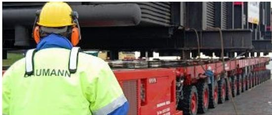
Auf einem Spezialfahrzeug mit 160 Rädern wird der riesige Kessel mit einer Länge von 33 und einer Breite von 8,5 Metern transportiert.
